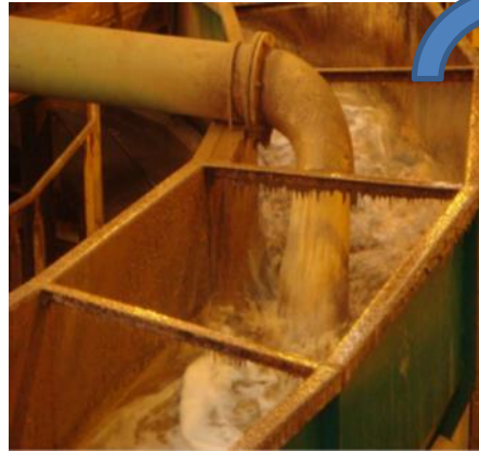
Extraction de l'eau pour réutilisation dans le process de lavage des betteraves (eaux terreuses)
